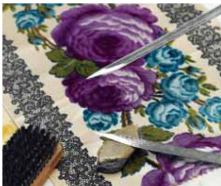
Matériel de découpe du velours au sabre : sabre, brosse et pierre à aiguiser*
